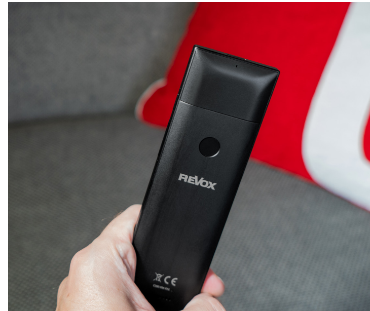
Auf der Rückseite ist ein Fingerabdruck-Sensor eingelassen – falls doch eine personalisierte Nutzung im eigenen Haushalt gewünscht ist.
