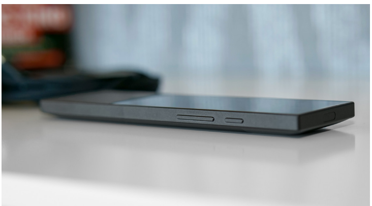
Die ultraflache Fernbedienung kommt mit einem Standby-Taster und einer Lautstärkewippe als Hard Keys aus.
