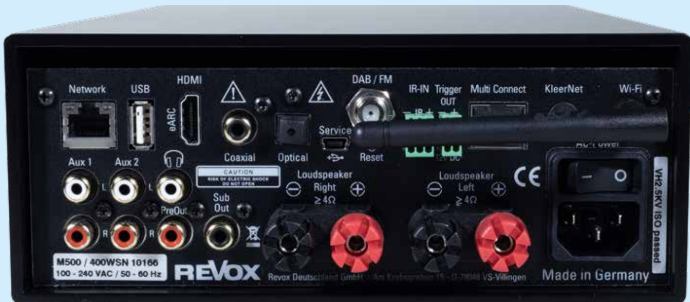
Vom Revox-Multi-Connect, bis hin zum Phono-Eingang bietet die Rückseite zahlreiche Verbindungsofferten. HDMI und eine Vielzahl weiterer, digitaler und analoger Anschlüsse stehen ebenfalls zur Verfügung
