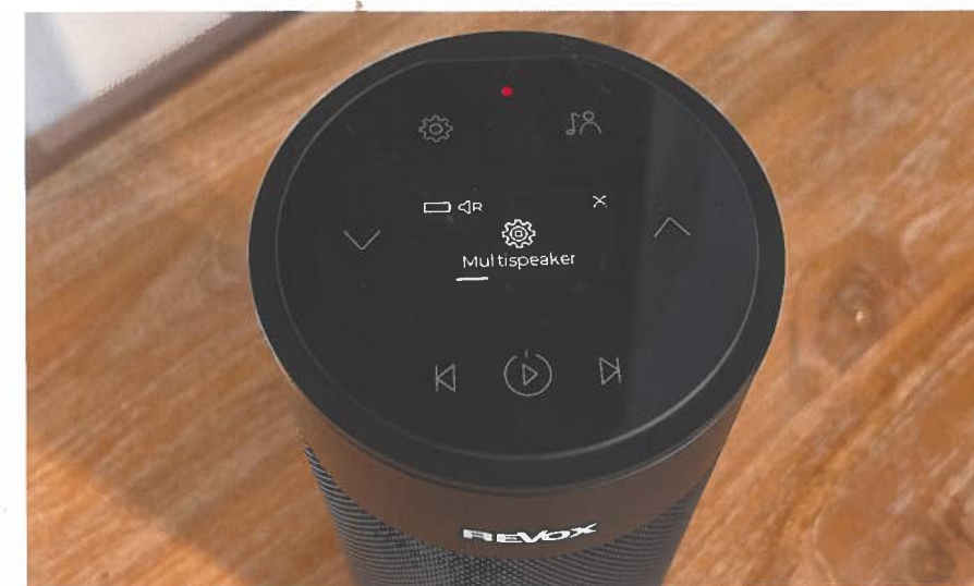
Die Touch-Tasten auf der Oberseite des Studiomaster A200 erlauben die schnelle Steuerung ganz ohne App
