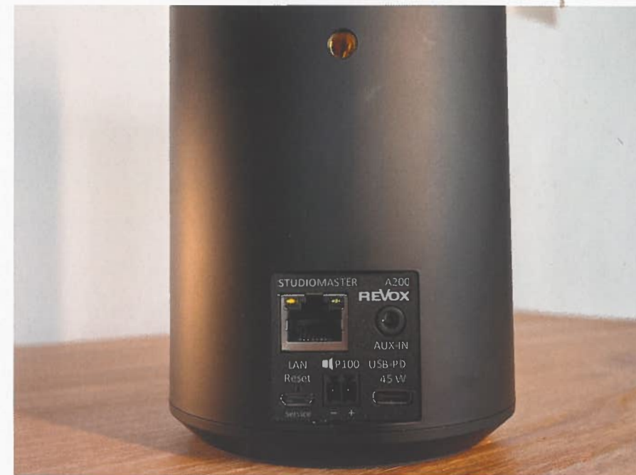
Die Rückseite zeigt die durchdachte Anschlussvielfalt: Neben LAN und Klinke bietet der A200 auch eine Bassreflexöffnung für stabile Tieftonwiedergabe
