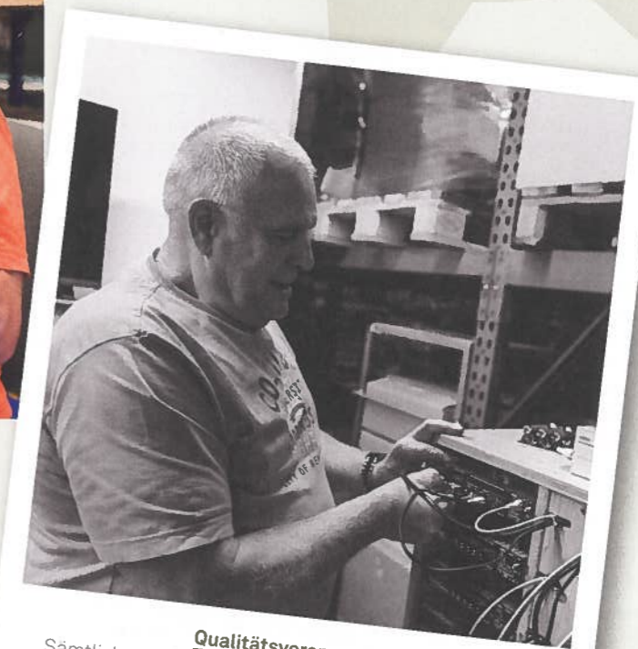
Qualitätsversprechen Sämtliche Geräte, wie hier die M30-Multiuser-Verstärker, werden vor der Auslieferung auf ihre korrekte Funktion und Leistung getestet.
