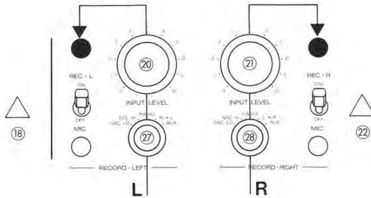
— Bei Stereo-Aufzeichnungen stehen die Eingangswahlschalter (27) und (28) auf den gleichen Positionen (MIC für Eigenaufnahmen; AUX oder RADIO für Aufnahmen von Verstärker oder Steuergerät).
