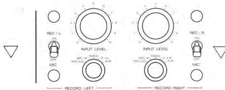
— Stehen beide Aufnahmevorwahlschalter auf OFF, ist keine Aufnahme möglich (Schutzstellung)
