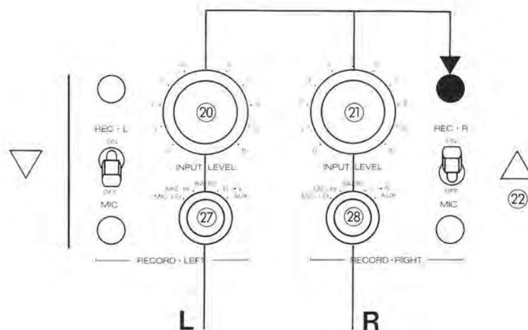
— Aufnahmevorwahlschalter REC R (22) auf ON (Ein). Der andere Aufnahmevorwahlschalter steht auf OFF (Aus). Bei Start des Tonbandes auf Aufnahme leuchtet die Aufnahmeanzeige (23).
